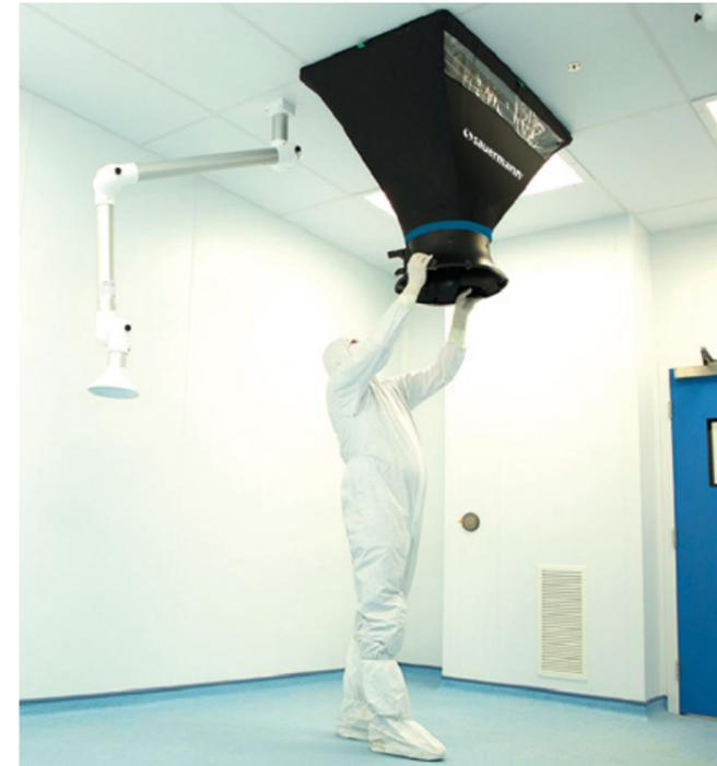
Elles peuvent également être équipées d'un dispositif permanent ou amovible permettant de redresser l'écoulement dans le cas d'un écoulement giratoire généré par un diffuseur en insufflation.
